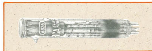
Fig. 47 - VIDICON . Il fascio si dirige verso il fotomosaico T ove incontra areole a diversa tensione: cede loro elettroni in dipendenza della loro luminosità, portandole così a potenziale zero poi può, di conseguenza, ritornare al collettore G2 . Gli elettroni lasciati dal fascio trasferendosi per capacità alla placca di segnale costituiscono la tensione di segnale.
