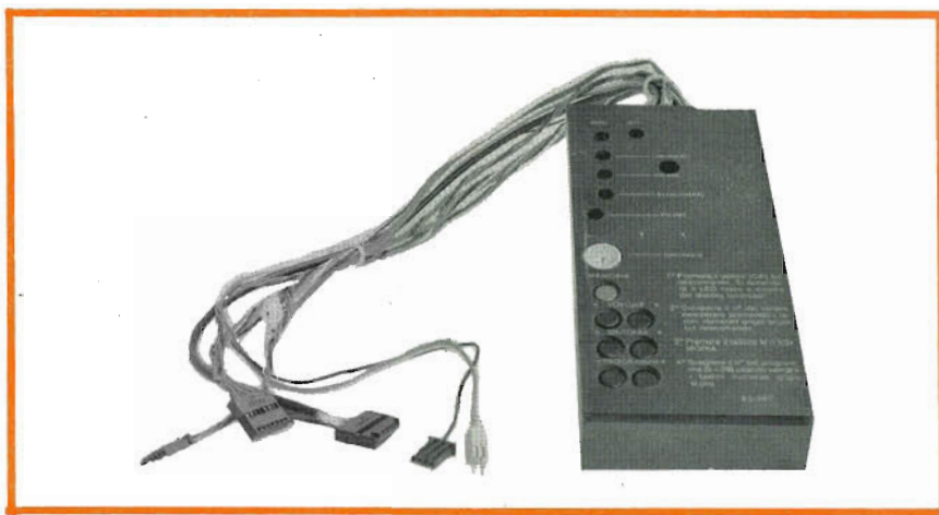
Fig. 105 - Questa "pulsantiera" si presenta come un cassetto estraibile pressoché interamente dal televisore, si da consentire l'azione su pulsanti e su potenziometri semifissi. Essenzialmente però la sua prerogativa è quella di agire a seguito di comandi (telecomandi) inviati a mezzo di raggi infrarossi e darne indicazione luminosa.
