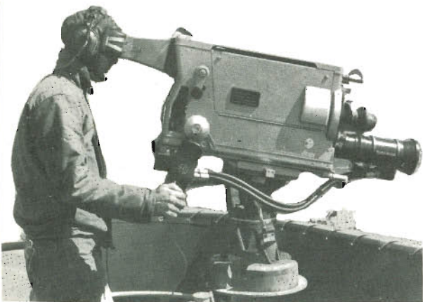
Fig. 44 - Telecamera professionale per ripresa all'aperto. Le telecamere di questo tipo sono sempre dotate oltre che di un'ottica commutabile anche di un visore di controllo che a volte, come in questo caso (impiego militare) prevede l'impegno attento e totale dell'operatore.
